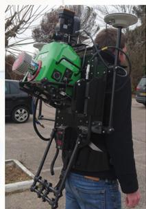
Pour compléter la collecte d'information et assurer la **fiabilité et l'exhaustivité des données**, Immergis effectue un relevé LiDAR 3D à pied, embarqué sur un véhicule ou en mode aérien.
